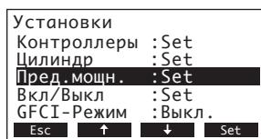
Выберете “Пред. мощн.” в меню настроек, нажмите кнопку <Set>. Установкой параметров в подменю “Пред. мощн.” Вы определяете, как должен функционировать Condair CP3: с фиксированным ограничением производительности (настраивается на заводе) или с таймером, регулирующим ограничение производительности. Примечание: установите желаемое ограничение производительности в % от максимальной производительности увлажнителя.
