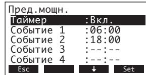
Если таймер активирован, может быть определено до 8 положений переключения (события 1 - 8) с различными ограничениями производительности.
