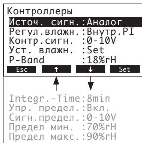
Появляются параметры настройки регулировки. Возможные параметры регулировки зависят от заданного источника сигнала и начала регулировки. На рисунке показаны максимальные значения имеющихся в распоряжении параметров настроек.
