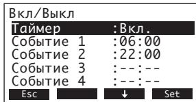
Если таймер активирован, может быть определено до 8 положений переключения (события 1 - 8) с различными Вкл/Выкл событиями.
