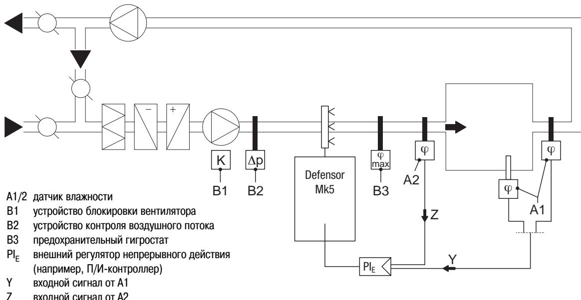
– Система 3: Регулирование по влажности приточного воздуха
