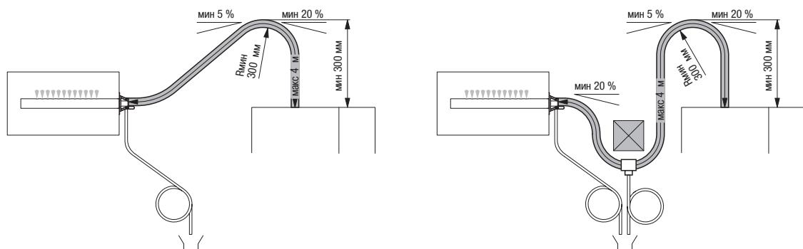
Сначала паровой шланг проводится **с подъемом как минимум 20% на высоту не менее 300 мм** над верхним краем увлажнителя, а затем вниз к парораспределительной трубе с **уклоном не менее 5%**.
