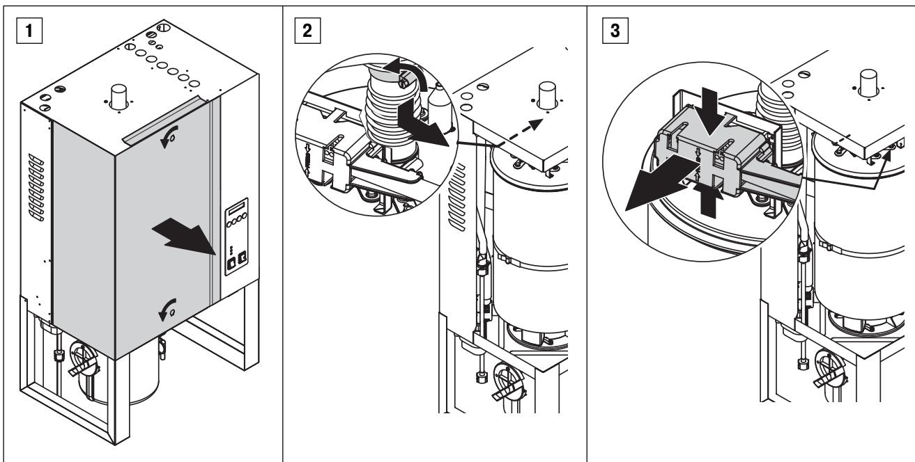
1. С помощью отвертки отоприте передние дверцы установки (поворните замки влево на 90°) и снимите дверцы.
