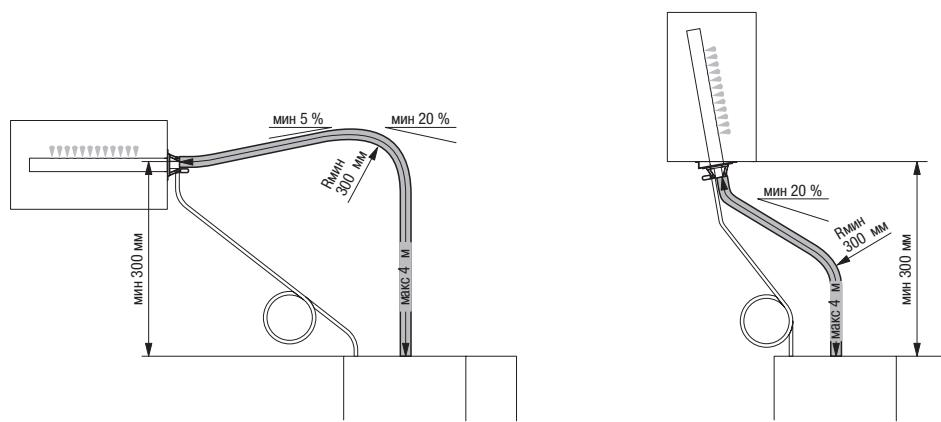
Сначала паровой шланг проводится **с подъемом как минимум 20% на высоту не менее 300 мм**, а затем с **подъемом не менее 20% и/или уклоном не менее 5%** к парораспределительной трубе.
