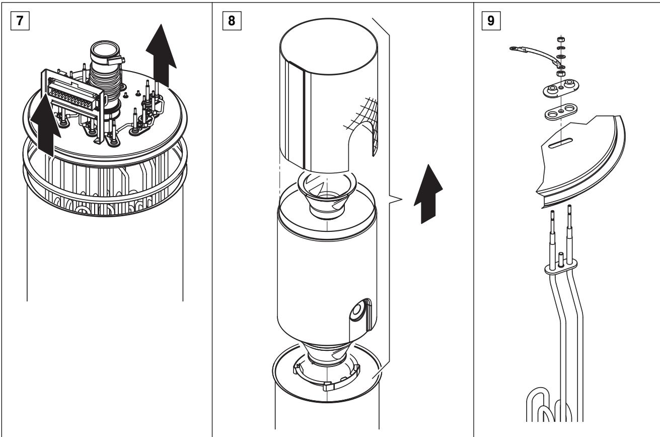
7. Аккуратно снимите крышку вместе с нагревательными элементами.
